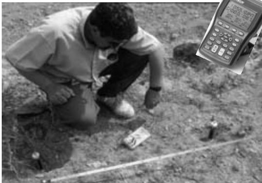
La presencia de campos eléctricos circulantes por el subsuelo representa un agravante en los factores de corrosividad para estructuras metálicas enterradas, dispongan, o no, de sistemas activos o pasivos de Protección Catódica. La determinación de la existencia y magnitud de campos eléctricos se realizó determinando el gradiente de potencial en el terreno, empleando una disposición de 2 electrodos, ubicados a una distancia fija, determinándose el valor del gradiente en mV/m.
